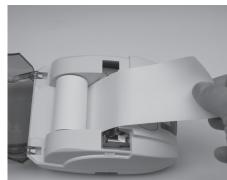
Cierre la tapa empujando en los dos lados de la cubierta del impresor por las aletillas de la tapa hasta que oiga un tronar. El papel ha sido cargado y esta listo para usar.
