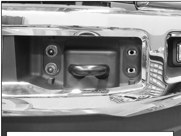
(Fig. 3) Quite solo los pernos exteriores del parachoques (se muestra el frente izquierdo/del conductor del parachoques).
