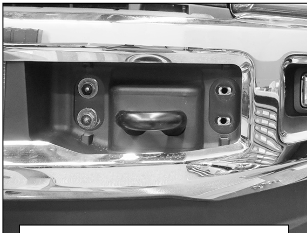
(Fig. 3) Retirer les boulons extérieurs du pare-chocs uniquement (avant gauche côté conducteur du pare-chocs illustré)
