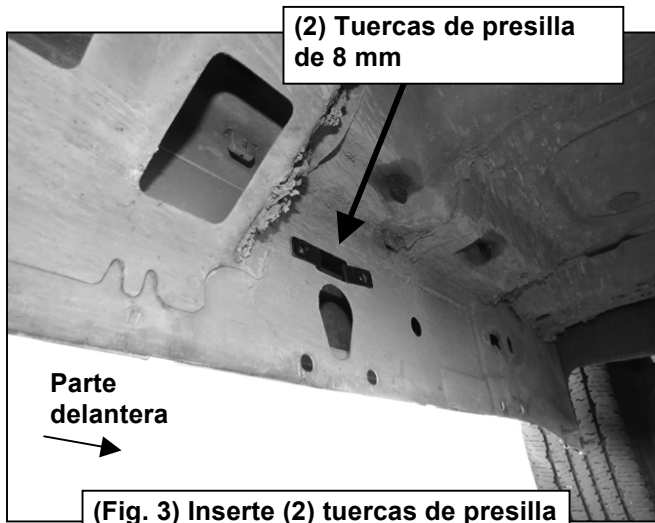
(Fig. 3) Inserte (2) tuercas de presilla de 8 mm en la abertura rectangular
