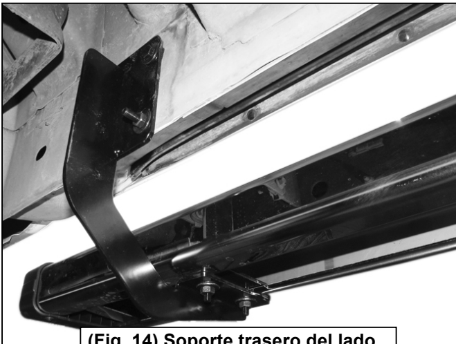
(Fig. 14) Soporte trasero del lado del conductor sujetado al estribo lateral
