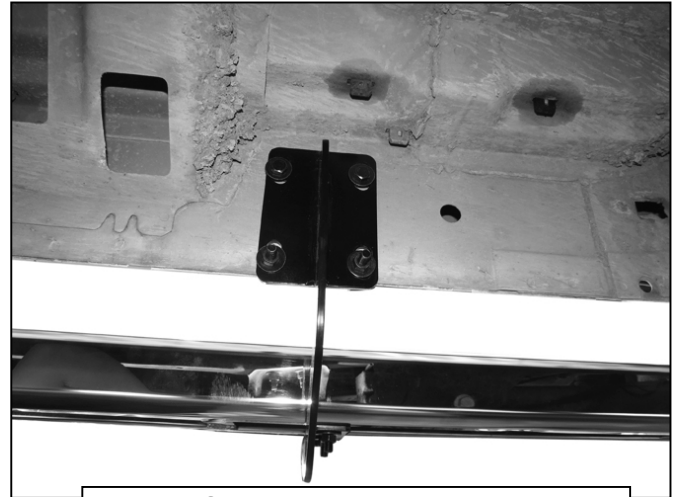
(Fig. 13) Soporte delantero del lado del conductor sujetado al estribo lateral
